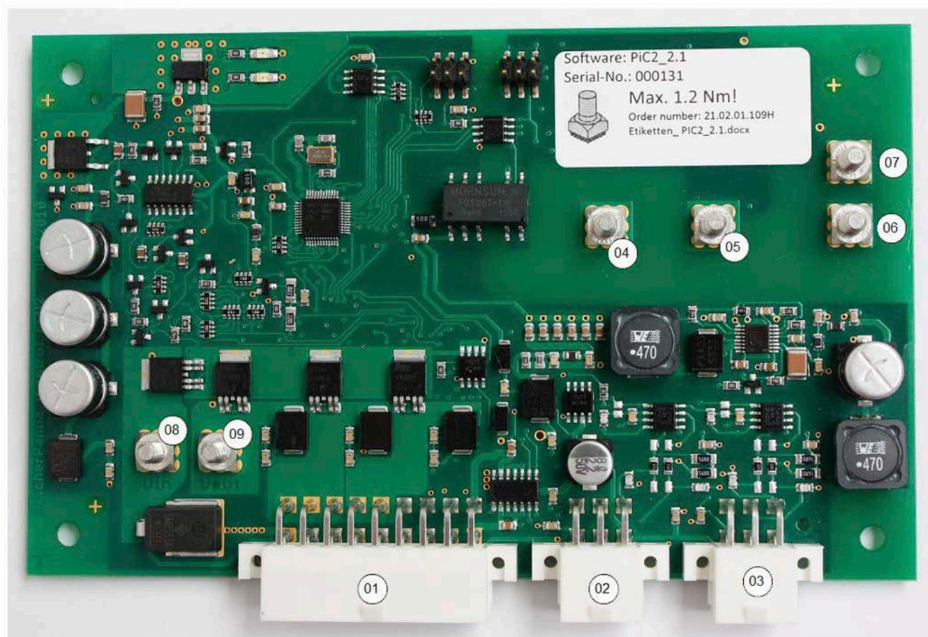
Das Panda iControl2-Steuergerät wird über die 18-polige Buchse mit dem Kabelbaum verbunden. Die mittlere 6-polige Buchse ist für den Fischer Panda Standard-Bus bestimmt. An diese Buchse wird das Panda iControl2-Panel angeschlossen. Der Fischer Panda CAN-Bus liegt auf der 6-poligen Buchse unten rechts auf der Leiterplatte. Die Belegungen der Steckverbinder sind in den nachfolgenden Tabellen angegeben. Siehe "Klemmenbelegungen am Panda iControl2-Steuergerät" auf Seite 144.
