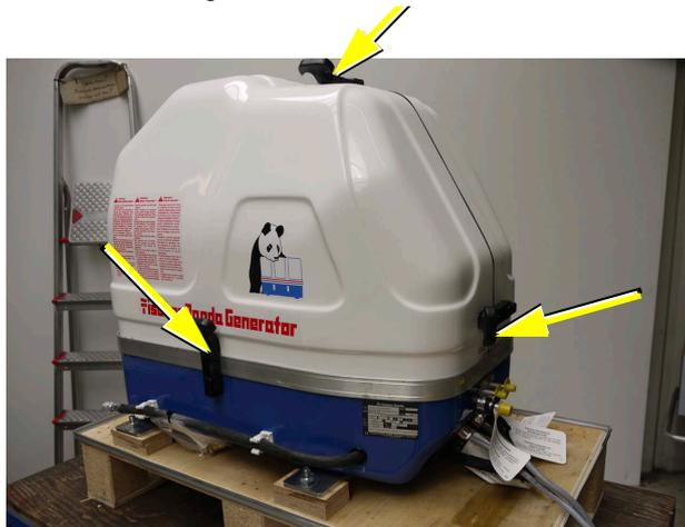
Zum Öffnen der Schalldämmkapsel müssen die Laschenverschlüsse in Pfeilrichtung gezogen und vom Verschlussunterteil abgehoben werden. Nach dem Öffnen aller Verschlüsse können die Kapseloberseite vom Unterteil abgehoben werden.
