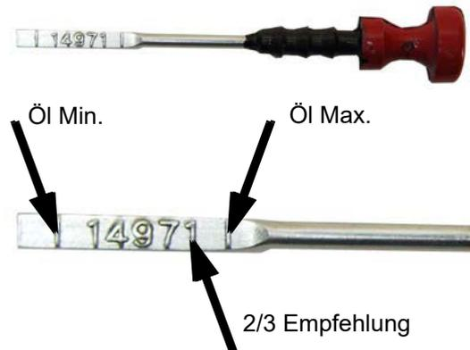
Liegt der Ölstand unter 1/3 zwischen der Minimummarkierung und der Maximummarkierung, sollte Öl nachgefüllt werden.
