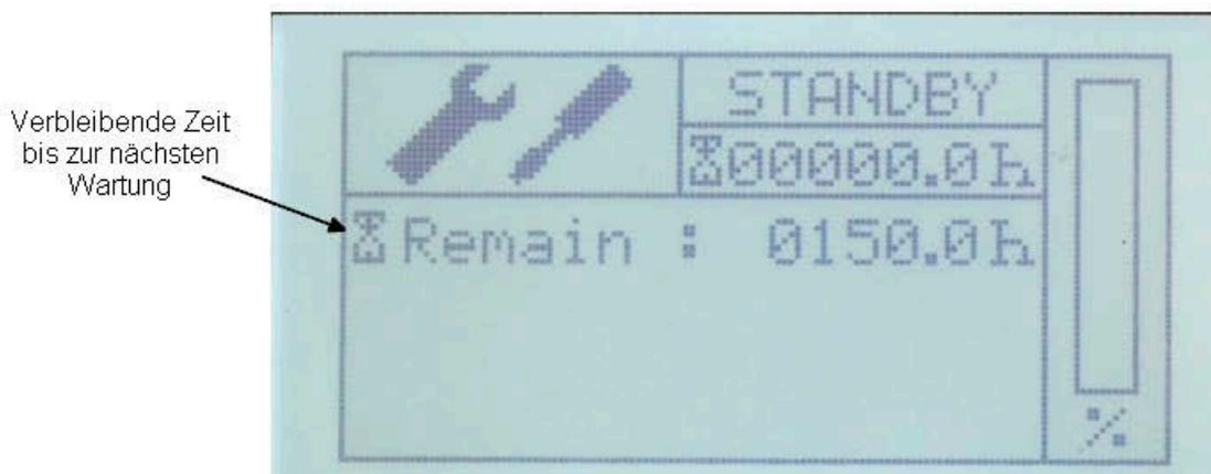
Die Gesamtbetriebsstunden des Generators werden auf der Standard-Displayseite und auf der Service-Info-Seite ausgegeben. Durch Betätigen der Cursor-Up- oder Cursor-Down-Taste im Standby-Modus gelangt man auf die Service-Seite. Diese Seite ist mit einem Schraubenschlüssel-/Schraubendreher-Symbol gekennzeichnet. Hier wird über die Zeit bis zum nächsten Service informiert. Durch wiederholtes Betätigen der Cursor-Up- oder Cursor-Down-Taste gelangen Sie zurück auf die Standard-Seite.
