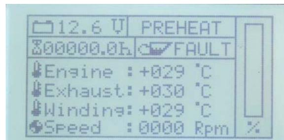
Bei Temperaturen unter 0 °C wird immer für 40 Sekunden vorgeglüht.
