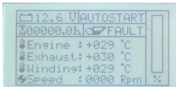
**Die Autostartfunktion bleibt auch nach dem Aus- und Wiedereinschalten der Steuerung über die On-/Off-Taste aktiv. Zur Deaktivierung der Autostartfunktion muss das Flag im EEPROM über „Disable“ zurückgesetzt werden. Siehe „Aktivieren/Deaktivieren der Autostartfunktion („Autostart“),“ auf Seite 134.**
