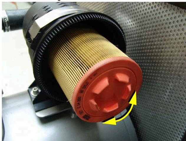
5. Säubern Sie das Filterelement, indem Sie es mit trockener komprimierter Luft ausblasen (max. 5 bar) oder ersetzen Sie das Filterelement spätestens nach 2 Jahren.
