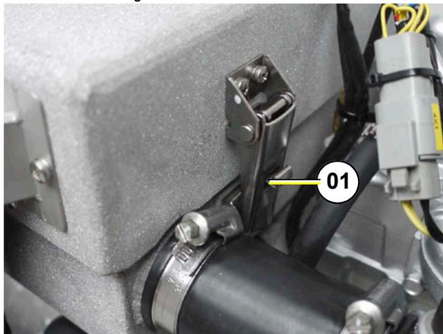
2. Öffnen des Verschlusses an der linken Seite des Luftansauggehäuses.
