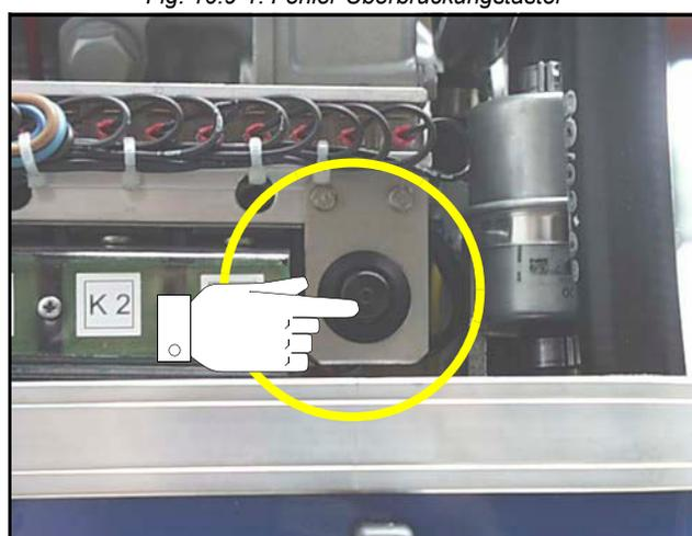
Fig. 10.9-1: Fehler-Überbrückungstaster
