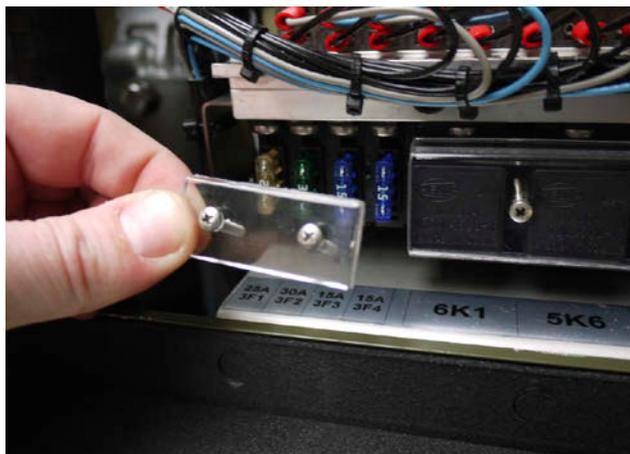
3. Mithilfe eines Sicherungsabziehers die Sicherung entfernen und durch eine neue ersetzen.
