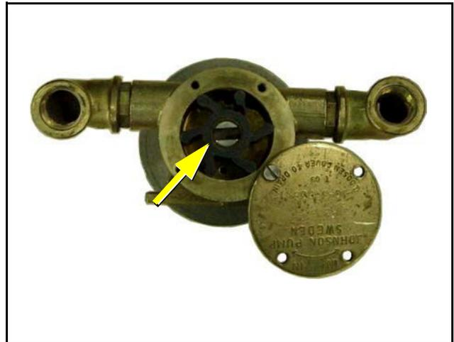
Fig. 10.5.3-5: Impeller
