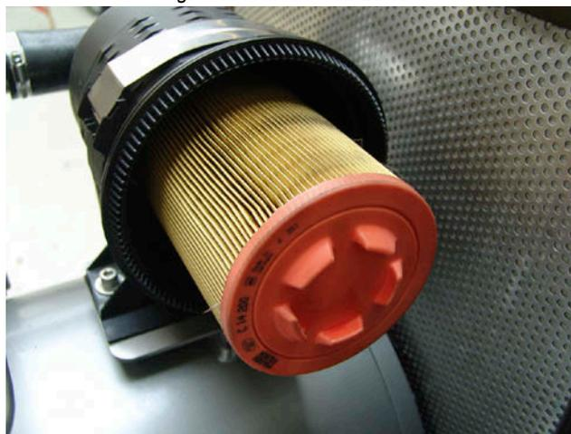
7. Filterpatrone in Faltrichtung ausblasen. Maximaler Druck: 5 bar.
