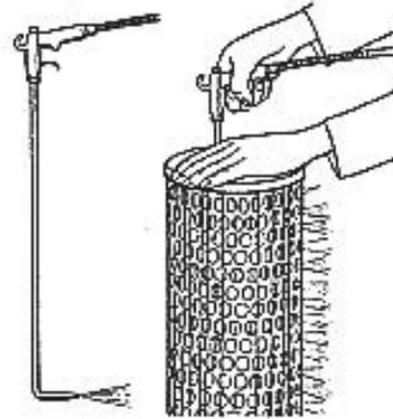
9. Filterpatrone mit Stablampe auf Beschädigung prüfen.
