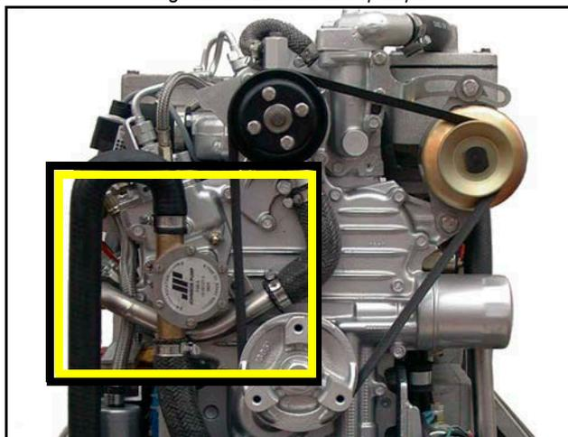
Entfernen Sie den Deckel der Seewasserpumpe, indem Sie die Schrauben auf dem Gehäuse lösen.
