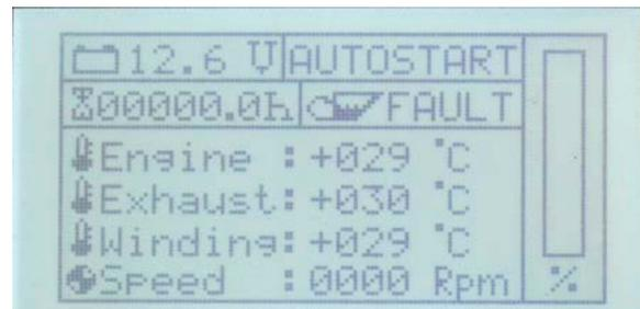
Die Autostartfunktion bleibt auch nach dem Aus- und Wiedereinschalten der Steuerung über die On-/Off-Taste aktiv. Zur Deaktivierung der Autostartfunktion muss das Flag im EEPROM wie oben beschrieben über „Disable“ zurückgesetzt werden.
