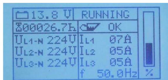
Auf dieser Seite sehen Sie die aktuelle Inverter-Außenleiterspannungen. Sie erreichen die Inverterseite durch die Betätigung der Cursor-Up-Taste im Operation-Mode.
