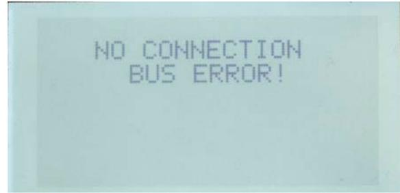
Beim Verlust der Kommunikation ist der Generator zu sichern (Batterietrennschalter öffnen) und alle Steckverbindungen und Kabel auf festen Sitz bzw. Beschädigungen zu überprüfen.
