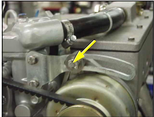
2. Die Schraube unter der Lichtmaschine lösen.
