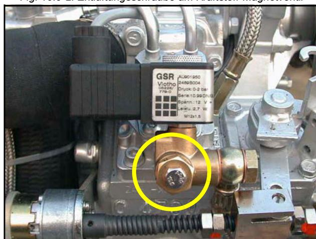
Fig. 10.9-2: Entlüftungsschraube am Kraftstoff-Magnetventil
