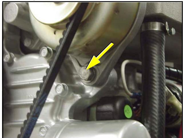
3. Die Lichtmaschine muss in Richtung des Thermostatgehäuse gedrückt werden.
