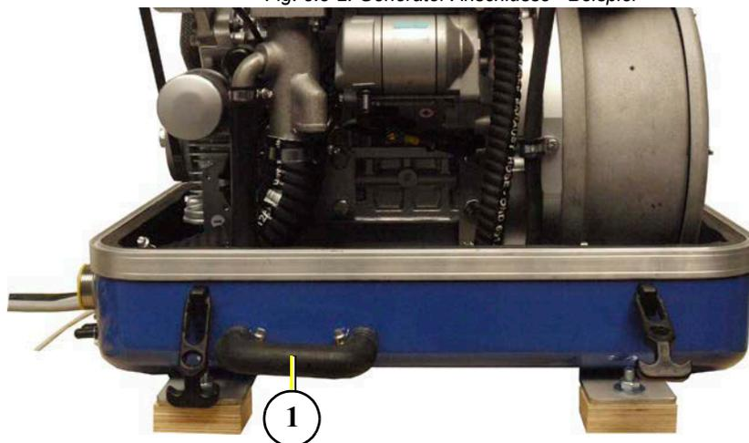
1. Anschluss externes Belüftungsventil
