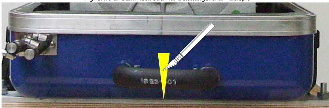
**Der Gummischlauch für das externe Belüftungsventil wird durchgeschnitten...**
