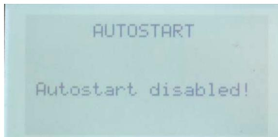
**Die Aktivierung/Deaktivierung der Autostartfunktion wird nun im EEPROM des Bedienpanels gespeichert.**
