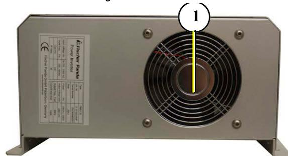
Durch den Generator liegt am PMGi eine lebensgefährliche Spannung von bis zu 550 V an. Das Gehäuse des PMGi darf nur vom ausgebildeten Fachpersonal geöffnet werden! **LEBENSGEFAHR!**
