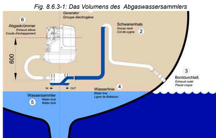
Wenn Zweifel bestehen, kann eine Überprüfung relativ einfach dadurch vorgenommen werden, dass vorübergehend ein klarsichtiger Schlauch (1) als Abgasschlauch verwendet wird. Dabei lässt sich das Kühlwasserniveau sehr leicht kontrollieren.
