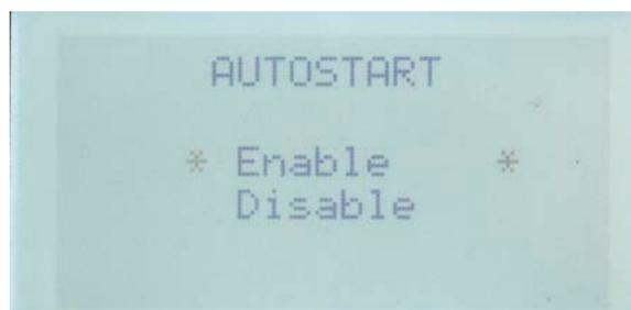
Wählen Sie bitte zur Aktivierung der Autostartfunktion „Enable“ aus und bestätigen Sie wiederum mit der Start-/ Stop-Taste.
