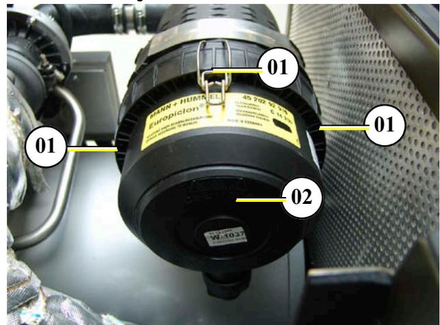
4. Entfernen Sie das Filterelement mit einer leichten Drehbewegung vollständig vom inneren Stützrohr.
