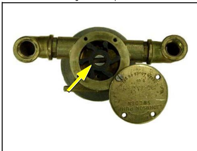
Fig. 7.7.2-5: Impeller
