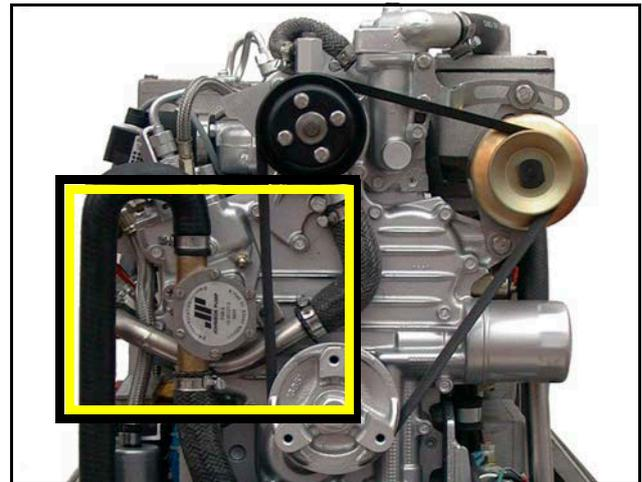
Entfernen Sie den Deckel der Seewasserpumpe, indem Sie die Schrauben auf dem Gehäuse lösen.
