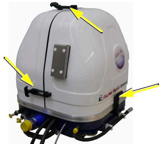
Zum Öffnen der Schalldämmkapsel müssen die Laschenverschlüsse in Pfeilrichtung gezogen und vom Verschlussunterteil abgehoben werden. Nach dem Öffnen aller Verschlüsse können die Kapseloberteile vom Unterteil abgehoben werden.
