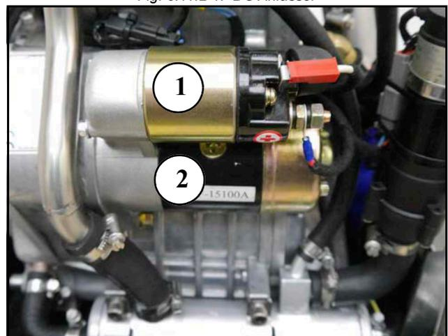
Das Pluskabel (+) der Batterie wird direkt an dem Magnetschalter des Anlassers angeschlossen.
