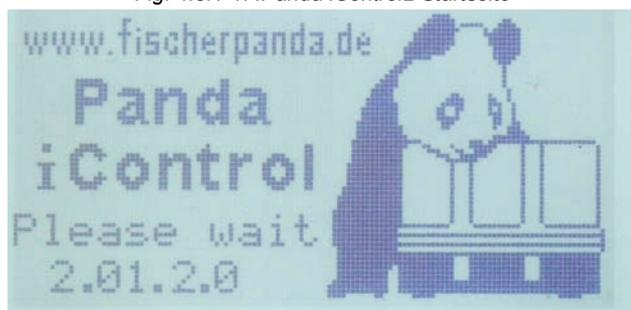
Fig. 4.3.1-2: Hardware-Version, Generatortyp und Software-Version im Standard-Display
