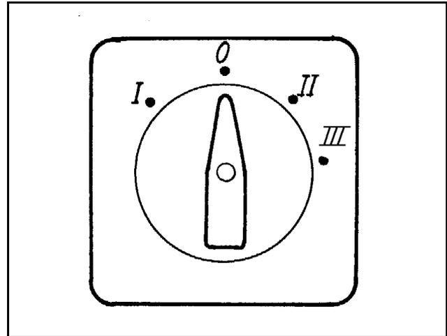
Der Nockenschalter muss zweipolig sein, damit sowohl „Mittelpunkt“ als auch „Phase“ abgeschaltet werden können.
