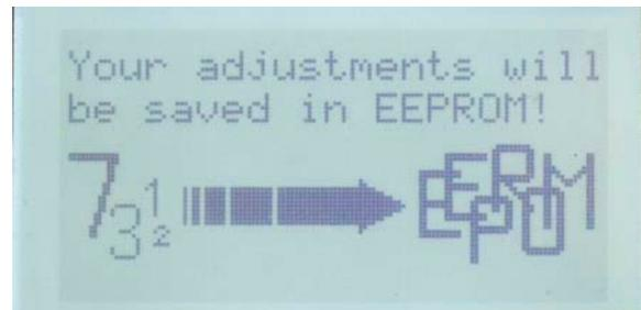
Anschließend wird für 3 Sekunden die Verabschiedungsseite eingeblendet und die Steuerung ausgeschaltet. Beim nächsten Start der Steuerung werden die Änderungen wirksam.
