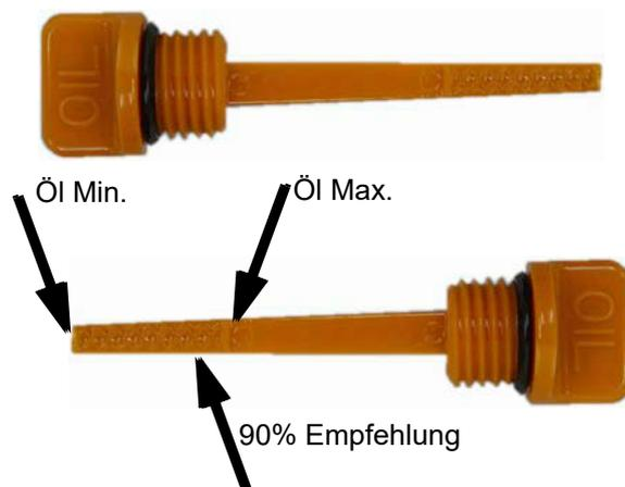
Liegt der Ölstand unter 50% zwischen der Minimummarkierung und der Maximummarkierung, sollte Öl nachgefüllt werden.
