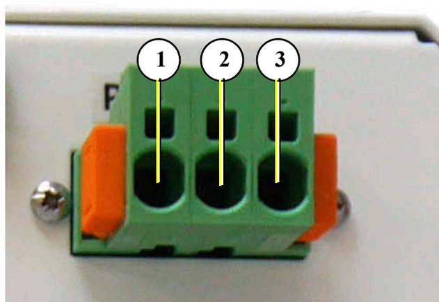
**Das Umschalten einer Phase auf Pin1 (Schutzleiter) zerstört den PMGi.**
