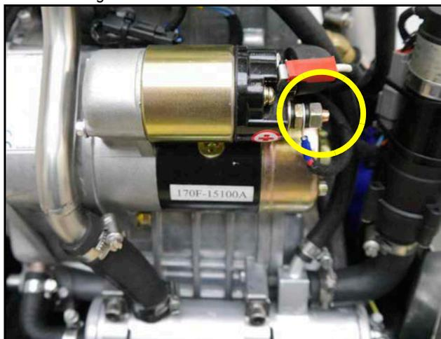
Das Minuskabel (-) der Batterie ist am Motor angeschlossen.
