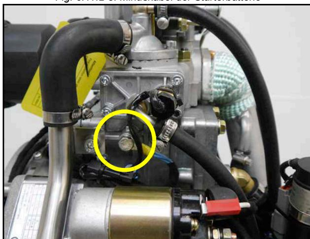
Fig. 6.11.2-4: Anschluss Starterbatterie 12 V - Schema
