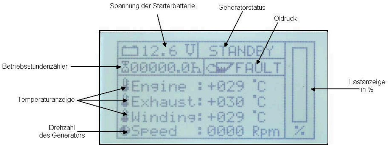
Das Display zeigt die iControl Board Eingangsspannung an. **Hinweis!**
