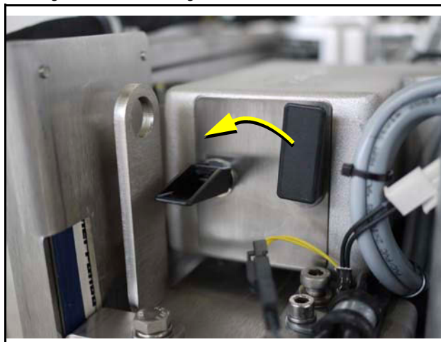
Fig. 10.8.1-2: Luftfiltergehäuse mit Schnellwechselhalter
