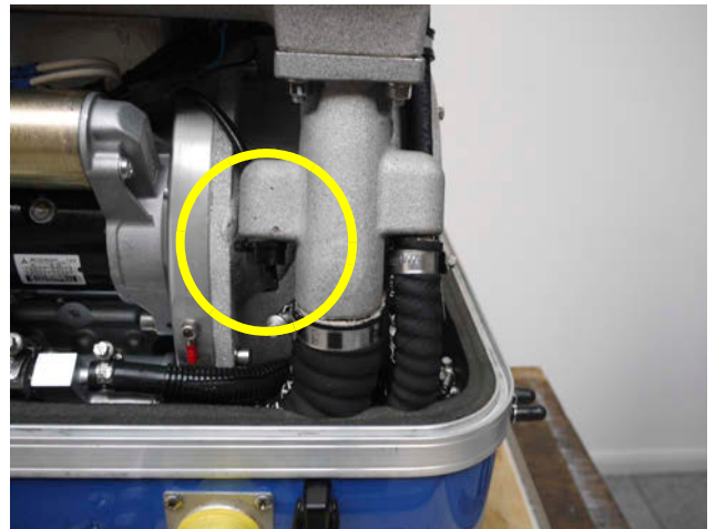
Fig. 7.3.6-2: Thermosensor am Abgaskrümmer
