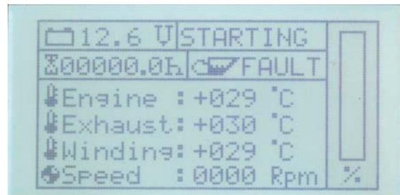
Die Steuerung führt nur einen Startversuch durch. Konnte der Generator nicht gestartet werden, werden Sie durch die Ausgabe „STARTING FAILS“ über das Fehlschlagen des Generatorstarts informiert.
