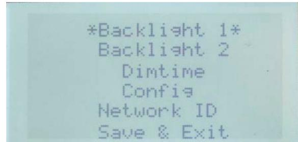
Die Start-/Stop-Taste wird im Setup-Menü zur Bestätigung verwendet. Wenn Sie die durch \* markierte Zeile mit der Start-/Stop-Taste bestätigen, erreichen Sie das ausgewählte Untermenü.
