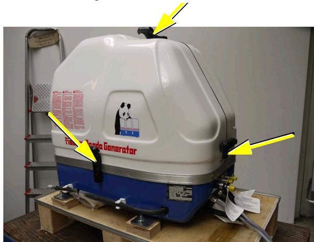
Zum Öffnen der Schalldämmkapsel müssen die Laschenverschlüsse in Pfeilrichtung gezogen und vom Verschlussunterteil abgehoben werden. Nach dem Öffnen aller Verschlüsse können die Kapseloberteile vom Unterteil abgehoben werden.
