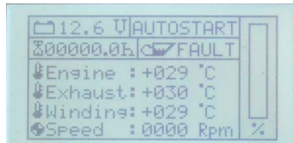
Fig. 14.4.6-7: Standard-Displayseite im Autostart-Modus
