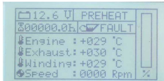
Fig. 14.3.3.2-1: Standard-Displayseite während des Vorglühens
