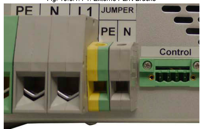
Fig. 19.5.1.4-1: Externe PE/N Brücke
