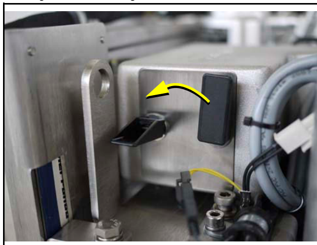
Fig. 9.8.1-2: Luftfiltergehäuse mit Schnellwechselhalter
