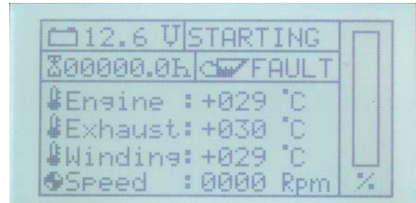
Fig. 14.3.3.2-2: Standard-Displayseite während des Startens
