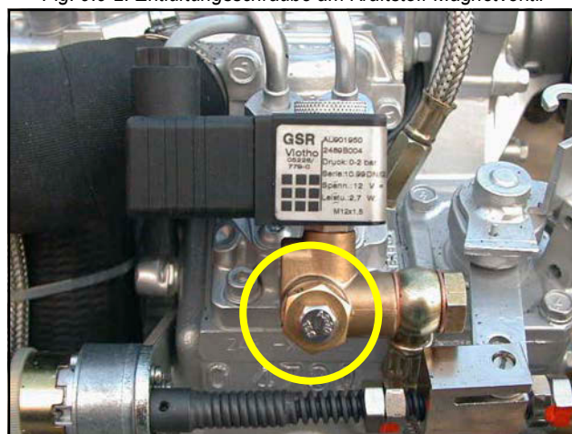
Fig. 9.9-2: Entlüftungsschraube am Kraftstoff-Magnetventil
