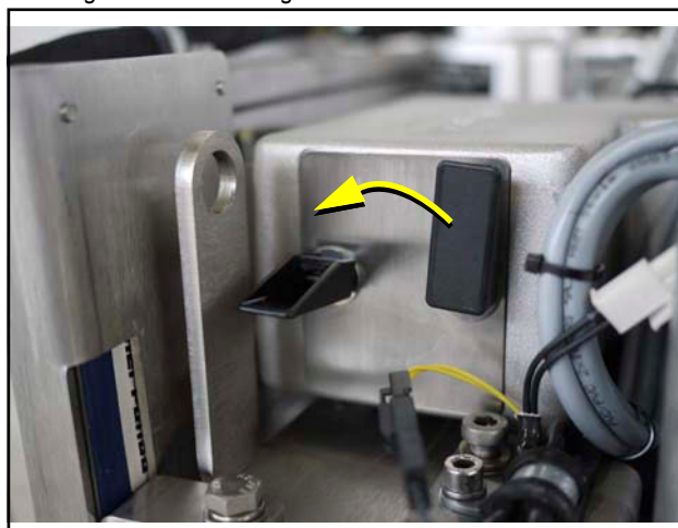
Fig. 9.8.1-2: Luftfiltergehäuse mit Schnellwechselhalter
