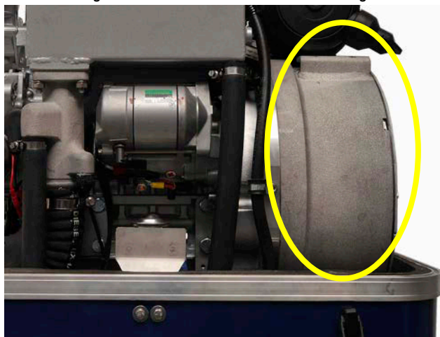
Fig. 6.4.5-3: Thermosensor in der Wicklung
