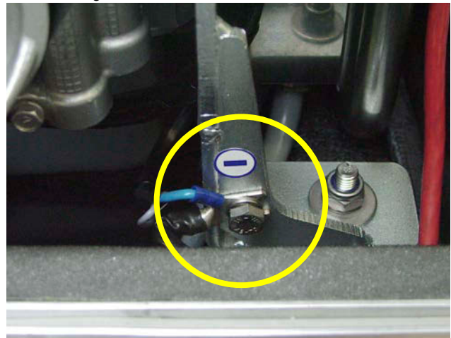
Fig. 6.10.3-5: Minuskabel der Starterbatterie
