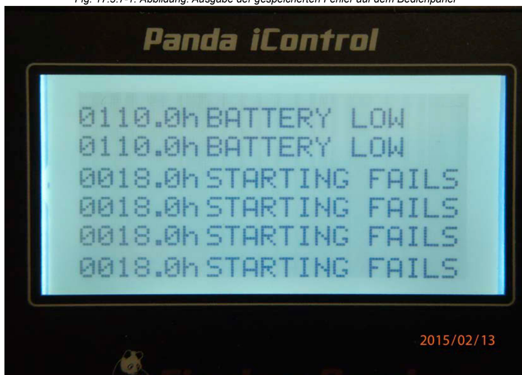
Fig. 17.3.7-1: Abbildung: Ausgabe der gespeicherten Fehler auf dem Bedienpanel
