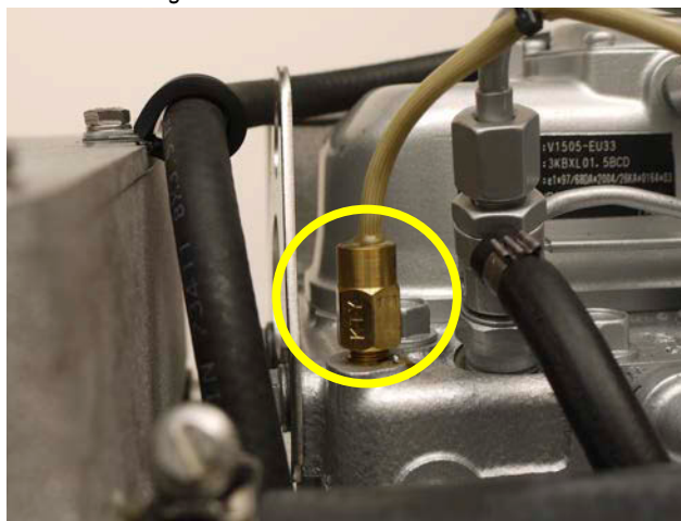
Fig. 5.4.5-2: Thermosensor am Abgaskrümmer
