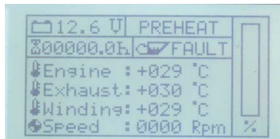
Fig. 14.3.3.2-1: Standard-Displayseite während des Vorglühens
