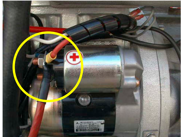
Fig. 6.10.3-5: Minuskabel der Starterbatterie
