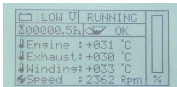
Fig. 17.1.1-1: Warnung „Batteriespannung zu niedrig“
