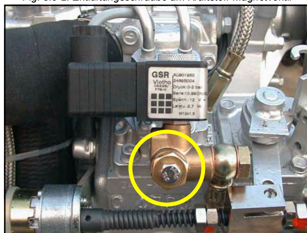
Fig. 8.9-2: Entlüftungsschraube am Kraftstoff-Magnetventil
