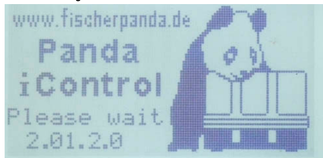
Fig. 14.3.1-2: Hardware-Version, Generatortyp und Software-Version im Standard-Display
