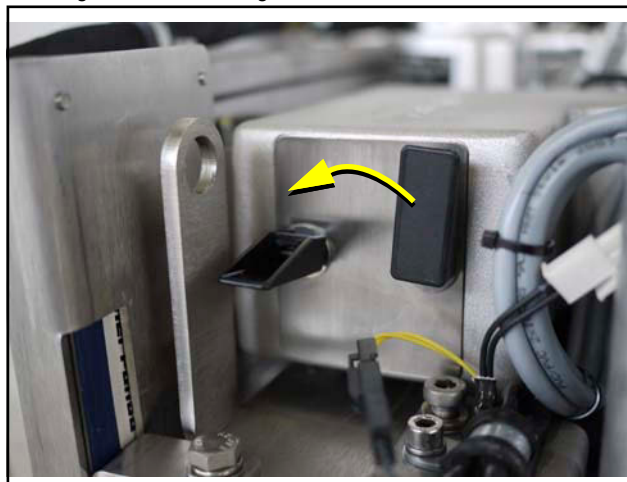
Fig. 8.8.1-2: Luftfiltergehäuse mit Schnellwechselhalter
