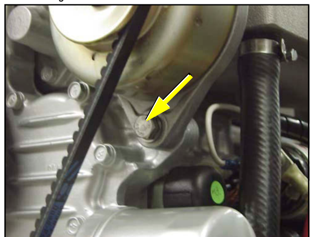
Fig. 8.15-2: Schraube unter der Lichtmaschine
