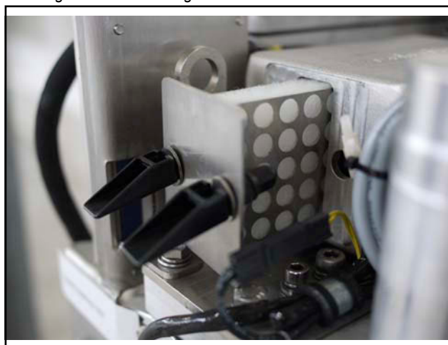
Fig. 8.8.1-3: Luftfiltergehäuse mit Schnellwechselhalter
