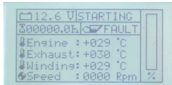
Fig. 14.3.3.2-2: Standard-Displayseite während des Startens
