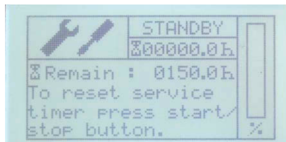
Fig. 14.4.7-1: Zurücksetzen der Zeit bis zur nächsten Wartung
