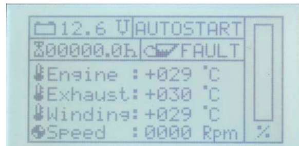
Fig. 14.4.6-7: Standard-Displayseite im Autostart-Modus
