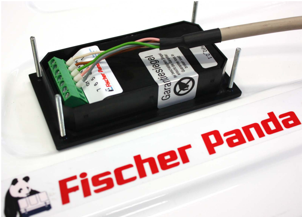
Fig. 16.2.1-1: Panda iControl2-Panel mit Panel-Anschlusskabel und geschlossenem Gehäuse
