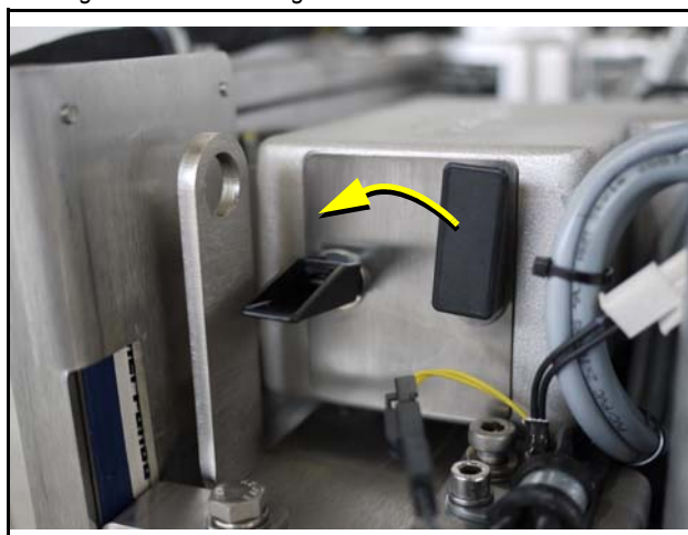
Fig. 10.8.1-2: Luftfiltergehäuse mit Schnellwechselhalter
