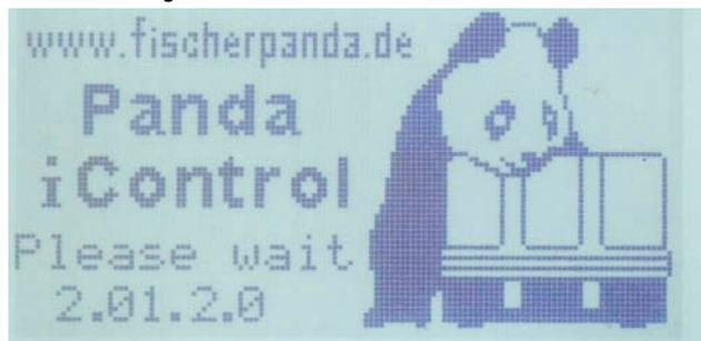
Fig. 14.3.1-2: Hardware-Version, Generatortyp und Software-Version im Standard-Display
