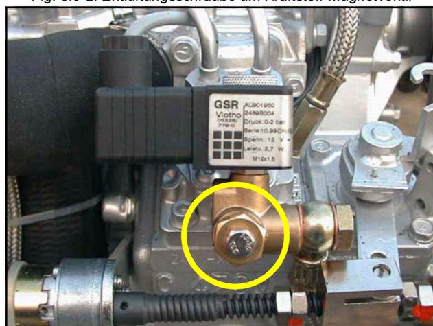
Fig. 8.9-2: Entlüftungsschraube am Kraftstoff-Magnetventil
