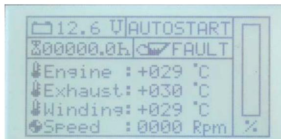
**Die Autostartfunktion bleibt auch nach dem Aus- und Wiedereinschalten der Steuerung über die On-/Off-Taste aktiv. Zur Deaktivierung der Autostartfunktion muss das Flag im EEPROM über „Disable“ zurückgesetzt werden. Siehe „Aktivieren/Deaktivieren der Autostartfunktion („Autostart“),“ auf Seite 158.**
