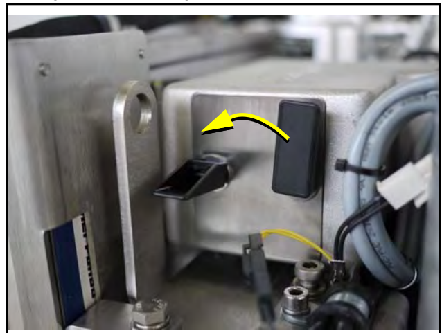
Fig. 9.11.1-2: Luftfiltergehäuse mit Schnellwechselhalter
